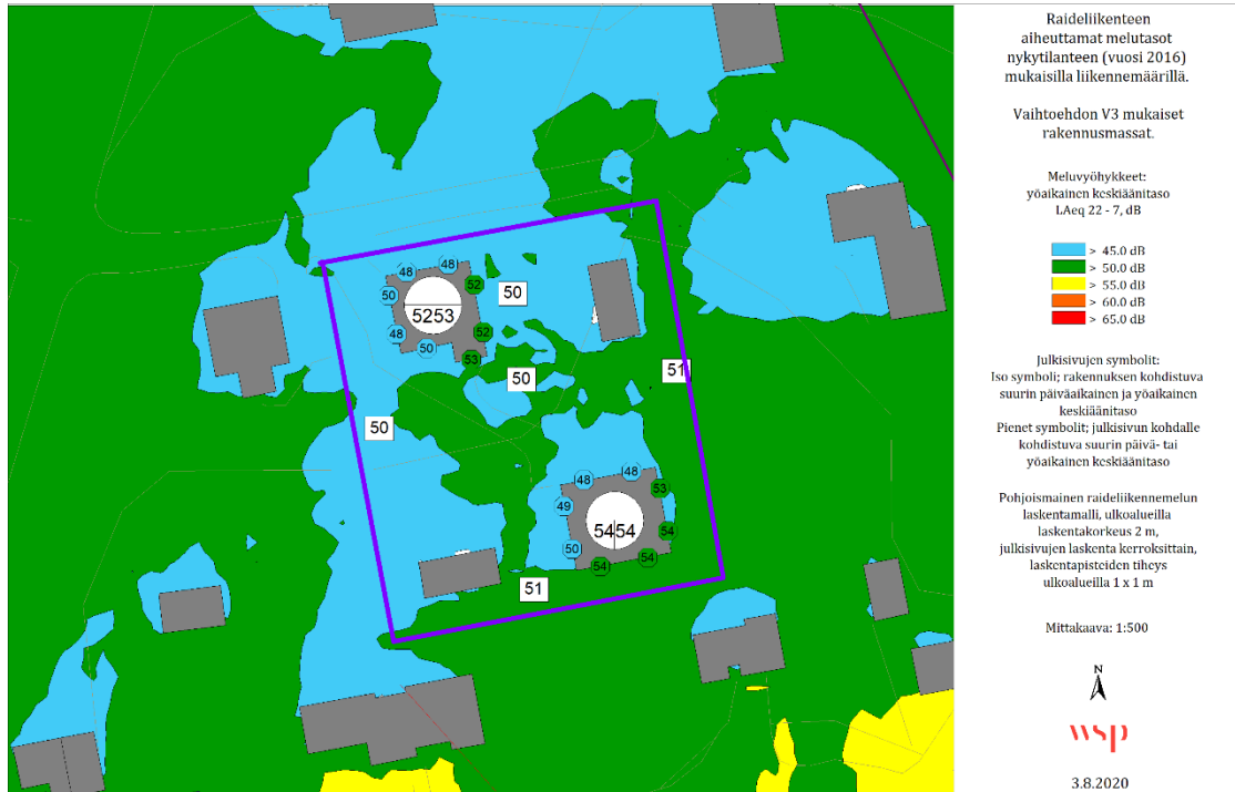
Kuva 5. Raideliikenteen aiheuttamat yöaikaiset keskiäänitasot ( L_{Aeq} 22-7 ) Ruohokuja 4:ssä vaihtoehdon 3 mukaisilla rakennusmassoilla nykyisillä liikennemäärillä. Asemakaava-alueen rajausta on merkitty sinisellä suorakulmiolla.
